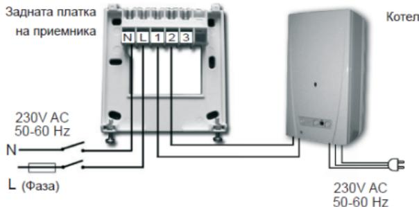
Ако желаете да управлявате стар котел или помпа, в които не са оформени специални контакти за подключване на термостата, клемите 1 и 2 се използват, както при обикновен прекъсвач на захранването, според следната схема:
